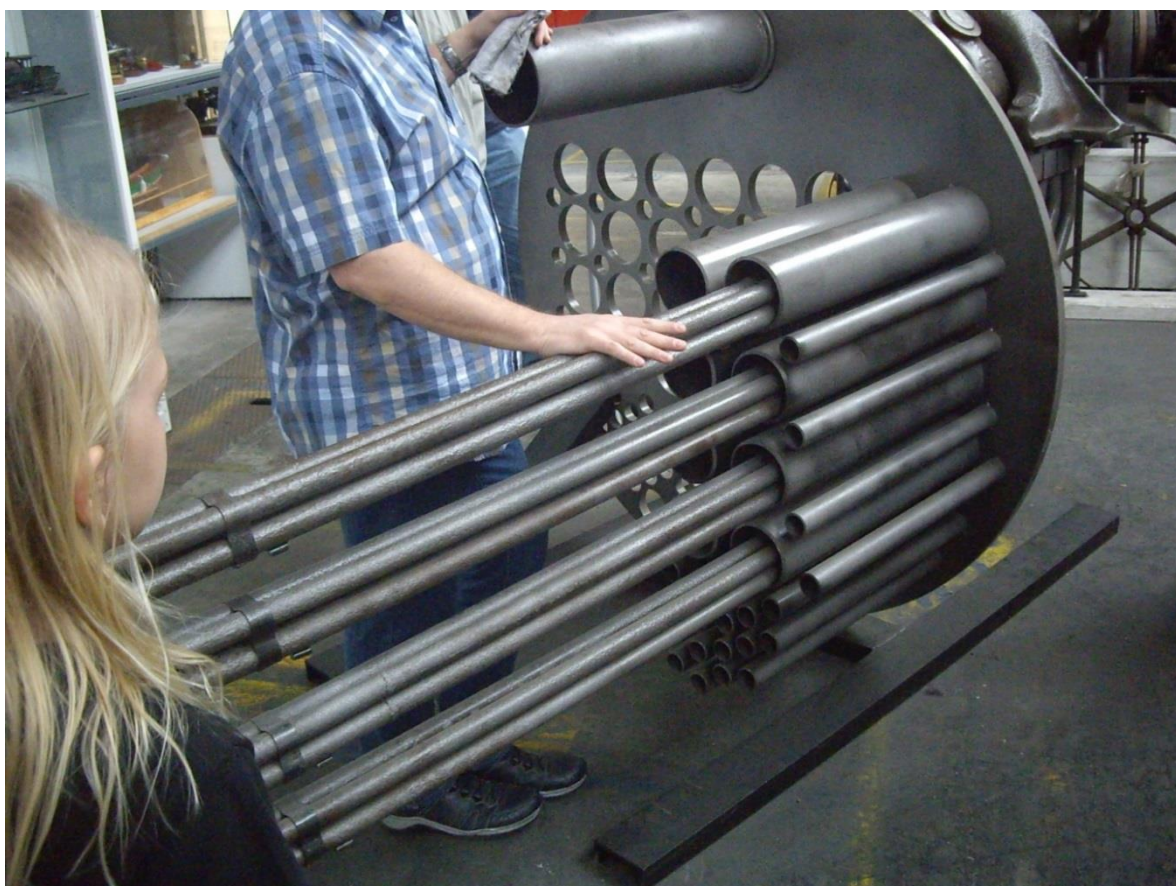
Erst durch die Schmidtsche Heißdampftechnik bekamen Dampfmaschinen und –Loks eine überzeugende Leistung. Wieder eine Erfindung aus Kassel, die die Dampfkraft revolutionierte.
