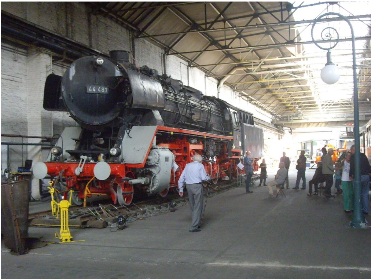
Schwere Güterzuglokomotive Baureihe 44 Achsfolge 1 E = 1 Laufrad, 5 Antriebsachsen mit vierachsigem Schleppender. Z.Zt. optische Restaurierung. Eine Betriebsfähigkeit ist nicht angestrebt.
